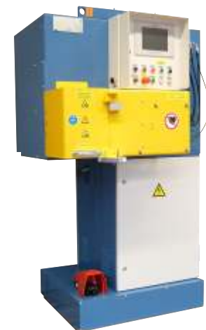
SS 80-FPC mit vertikaler, hydraulischer Spannvorrichtung und motorisch fahrbar in einer Achse oder schwenkbar an horizontalem Ablauf
