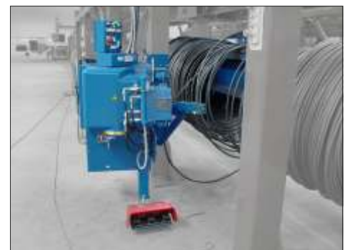
3a-NV mit vertikaler, hydraulischer Spannvorrichtung schwenkbar an horizontalem Ablauf
