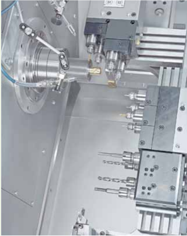
Linearer Werkzeugaufbau mit zusätzlichen Frässpindeln
