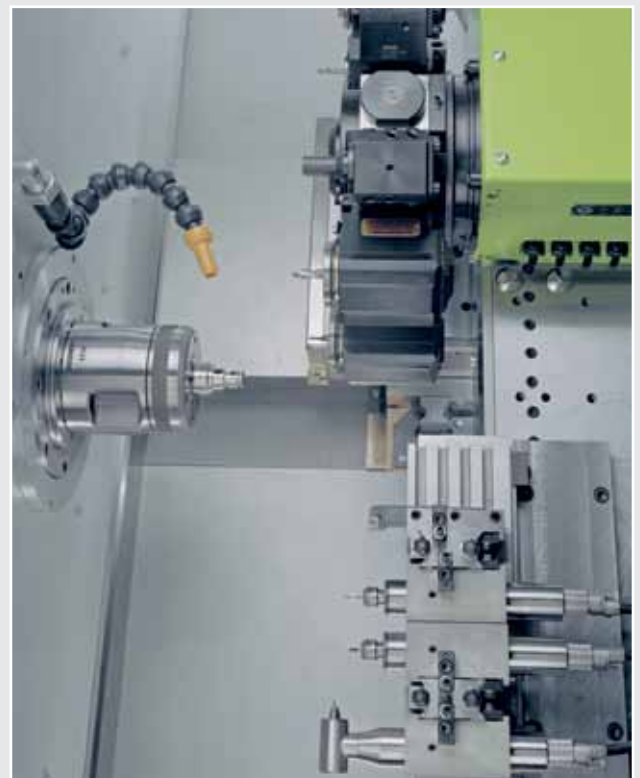
Werkzeugrevolver in Sternbauform Größe VDI 25 mit 12-fach Einzelplatzantrieb und zusätzlichem Linearwerkzeugaufbau mit 3 Hochfrequenzspindeln
