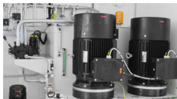
Hydraulisk centralenhet för varje ramp.
